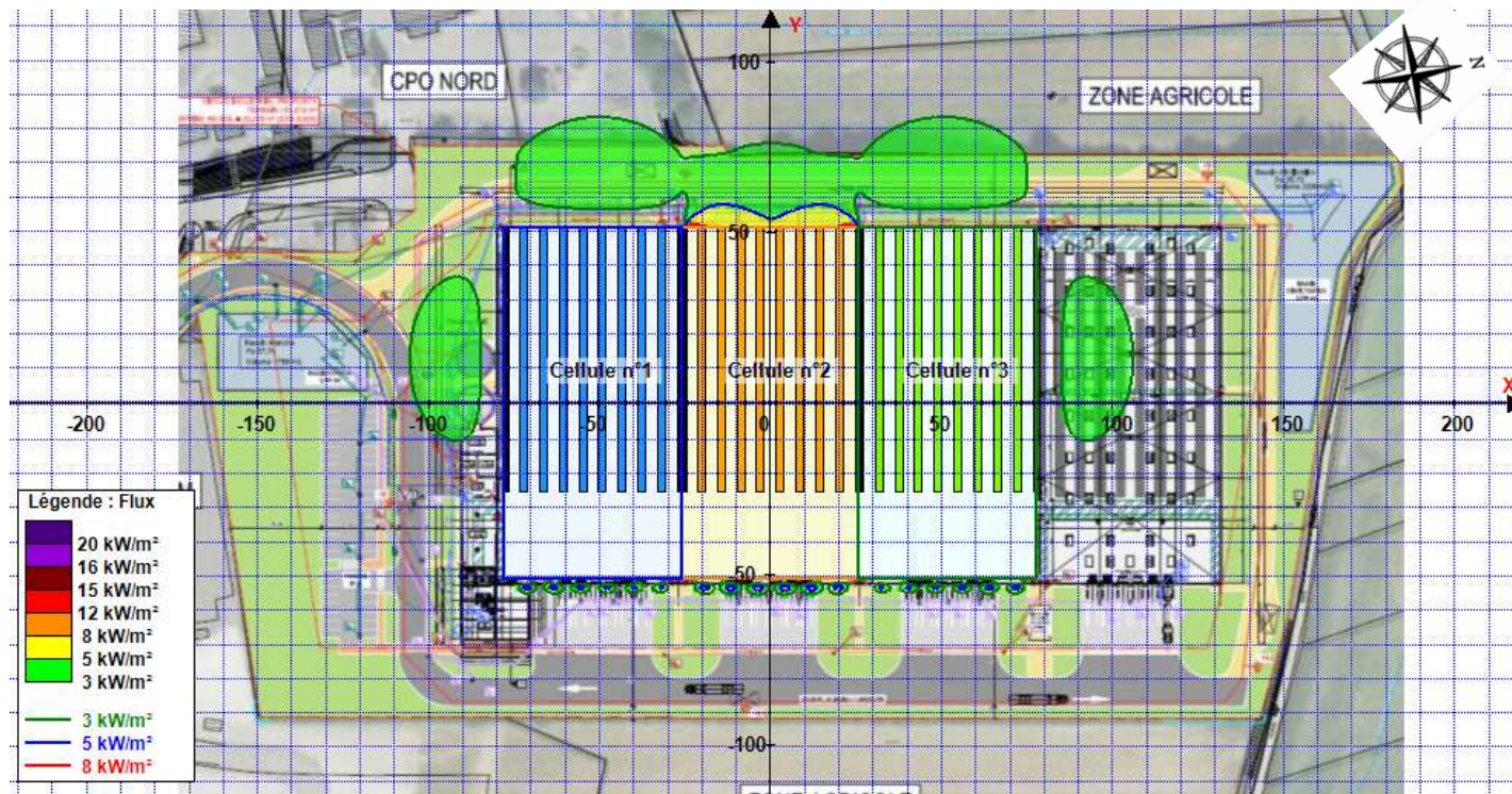
Figure 4 : Représentation des flux thermiques de la propagation de l'incendie aux cellules de stockage C1/C2/C3 (départ de feu en cellule 2) pour un stockage en 1510
